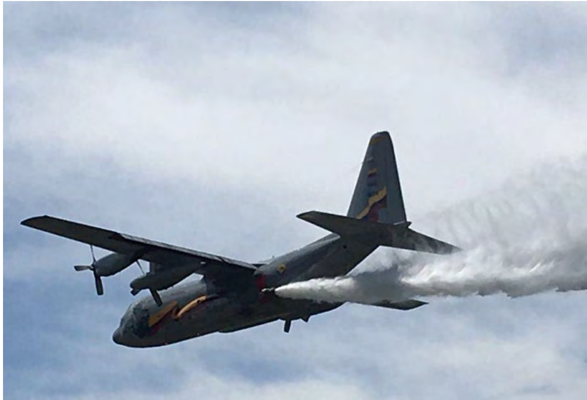
Sistema modular de extinción de incendios MAFF II, Incendio Forestal La Macarena, Meta
