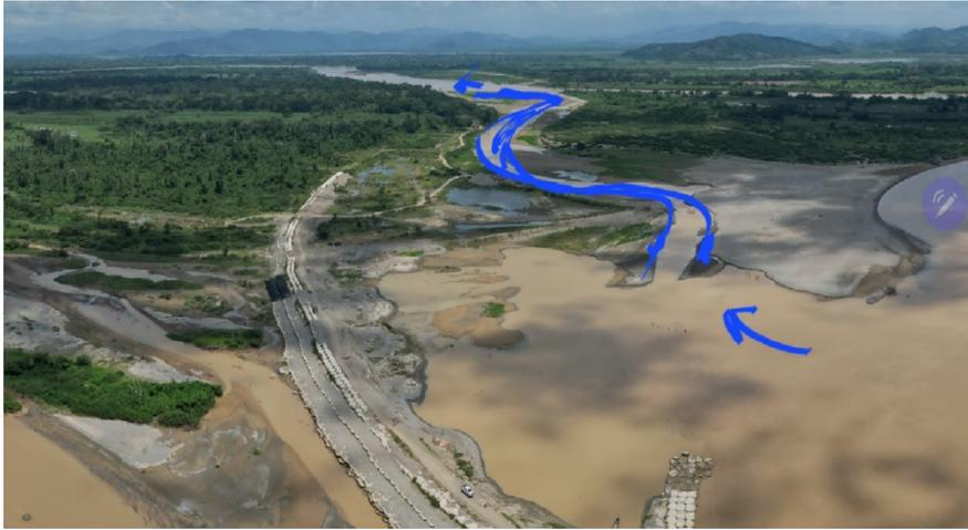
*Fotografía 33. Panorámica de las obras de cierre de Caregato el 19 de septiembre de 2024. A pesar de la colmatación, aún se conserva flujo en condiciones de estiaje por el canal del río Cauca.*
