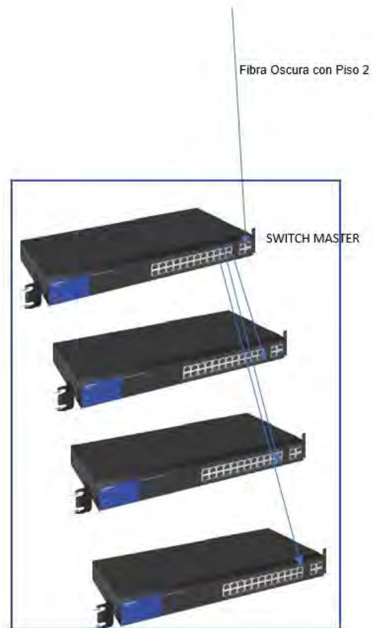
Ilustración 4. Red LAN: Infraestructura sede piso 4
